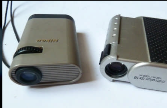
Gummiring verschiebt sich beim Fokussieren
